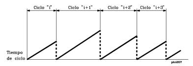
Con objeto de evitar la ejecución de ciclos que por su duración alteren el funcionamiento de la máquina, o la ejecución de un ciclo que por error de programación no tiene fin , el CNC limita el "tiempo de ciclo" a la mitad del tiempo que se ha asignado al Módulo Principal (PRG). En caso contrario se produce "Error de Watch Dog".
