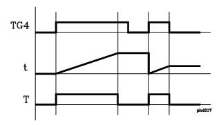
Si el temporizador se encuentra inicializado con los valores TEN=1 y TRS=0, el temporizador se activará al producirse un flanco de subida en la entrada TG4. En este momento la salida de estado del temporizador (T) cambia de estado (T=1) y comienza la temporización t a partir del valor 0.
