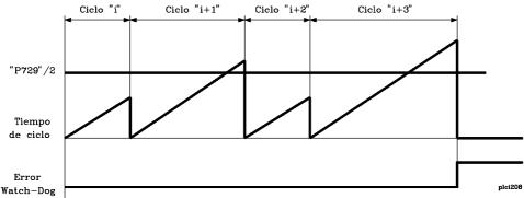
Por lo tanto, si al parámetro máquina correspondiente (P741 o P729) se le asigna el valor 5, el módulo principal (PRG) comenzará a ejecutarse cada 50ms. y la duración de cada uno de los ciclos deberá ser inferior a 25ms, en caso contrario se produce "Error de Watch Dog".
