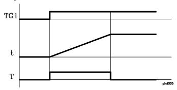
Si el temporizador se encuentra inicializado con los valores TEN=1 y TRS=0, el temporizador se activará al producirse un flanco de subida en la entrada TG1. En este momento la salida de estado del temporizador (T) cambia de estado (T=1) y comienza la temporización t a partir del valor 0.
