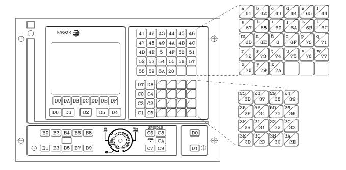
Nota: La tecla puede ser simulada en modo Manual y en combinación con las teclas de JOG (desplazmientos de ejes).
