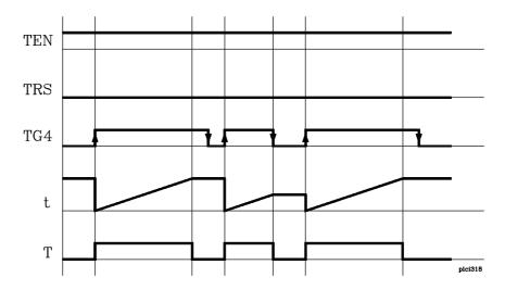
Una vez transcurrido el tiempo especificado mediante la constante de tiempo se dará por finalizada la temporización. La salida de estado del temporizador (T) cambia de estado (T=0) y el tiempo transcurrido se mantendrá como valor de tiempo del temporizador (T).
