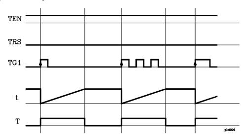
Una vez transcurrido el tiempo especificado mediante la constante de tiempo se dará por finalizada la temporización. La salida de estado del temporizador (T) cambia de estado (T=0) y el tiempo transcurrido se mantendrá con el valor de tiempo del temporizador (T).
